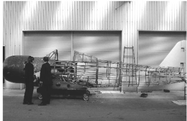
「人間の翼」の零戦は、「君を忘れない(木村拓哉主演)」で使用したものを購入。外板(ベニア)をはがし、当時の設計図や資料をもとに細部にわたり全て手作業で行われた。(全長10M 両翼12M 原寸大。 ロビンエンジン3基固定 プロペラ可動)
